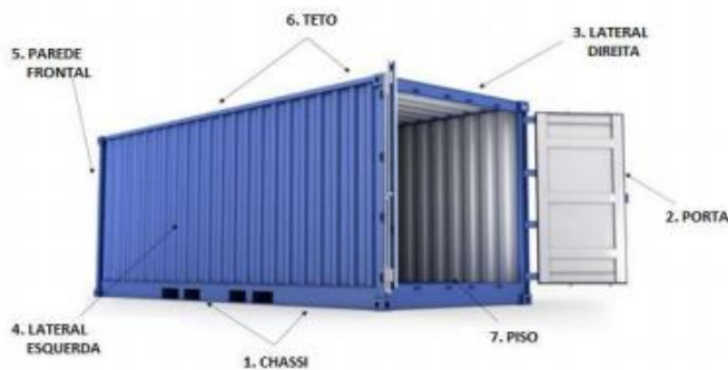
Fig. 16 – Inspeção dos sete pontos dos contêineres.
